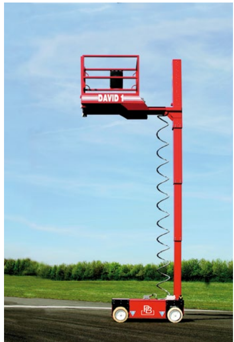
Bild 3-2: Stempelmastbühne Typ 3A
