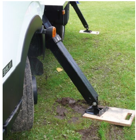
Bild 4-4: Gute (hinten) und schlechte (vorne) Abstützung
