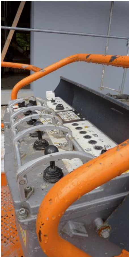
Bild 6-3: Schutzbügel gegen unbeabsichtigtes Betätigen der Bedienelemente
