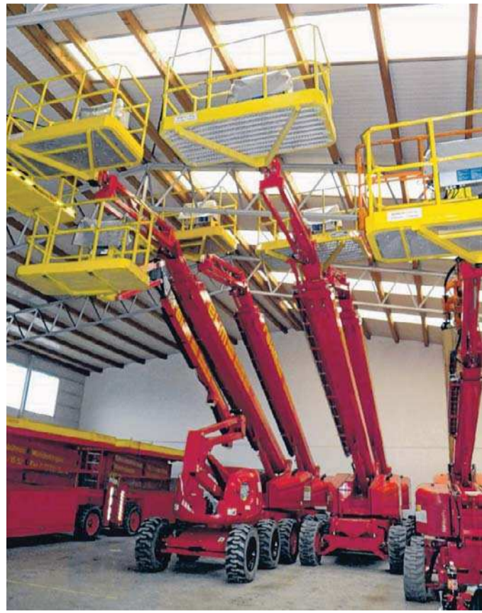
Teleskop-Arbeitsbühnen erlauben Tätigkeiten in großer Höhe.
